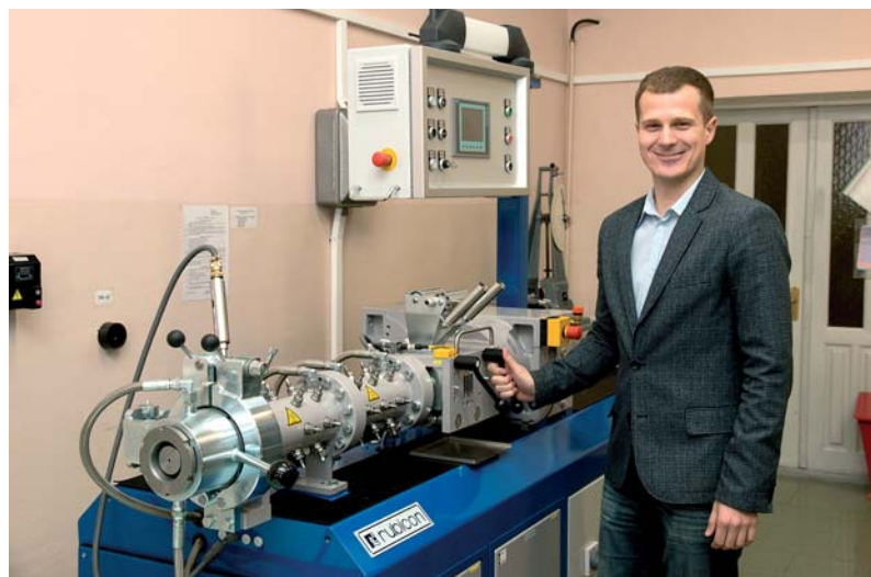
Младший научный сотрудник кафедры Вадим Мяделец осуществляет наладку штифтового экструдера для последующего формования резиновых смесей.
